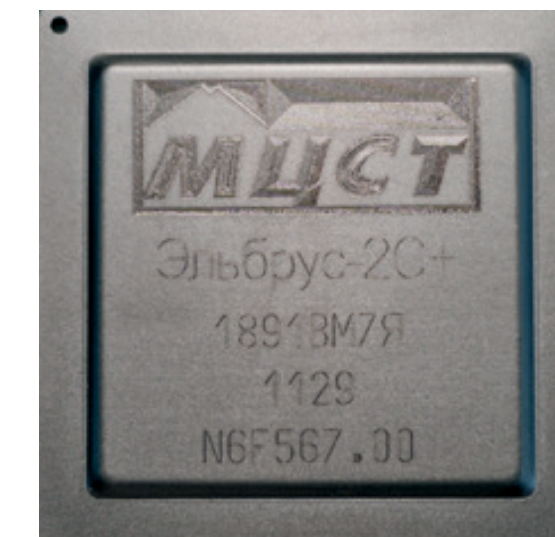
Процессор Эльбрус 2С+ 2 ядра с тактовой частотой 500 МГц
